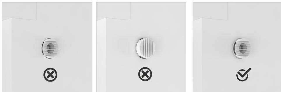
L'évacuation des condensats doit toujours être orientée vers le bas.
